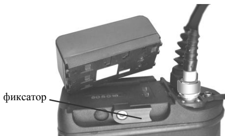
Рис.6 Расположение аккумулятора и блока приемопередатчика при установке
