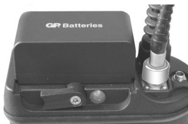
Рис.8 Вид на установленный аккумулятор. Фиксатор закрыт.
