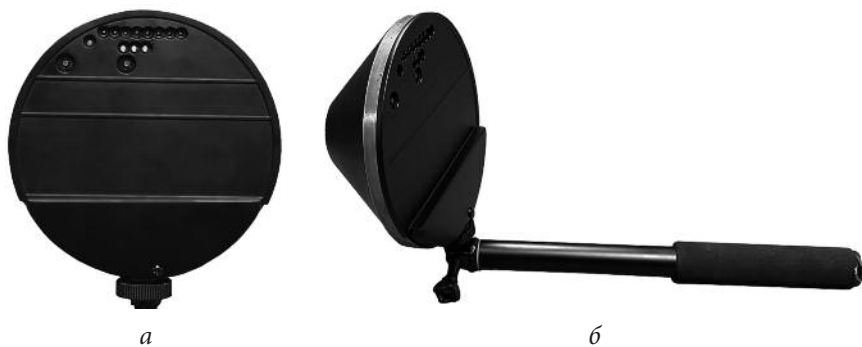
Рис. 1. Внешний вид нелинейного радиолокатора НРБТ: а) моноблок; б) с присоединенной штангой
