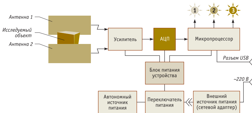
Рис. 3. Структурно-функциональная схема изделия NR-BOX
